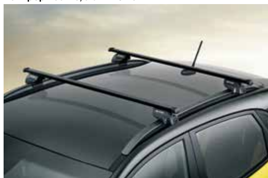
Belki poprzeczne, stalowe
