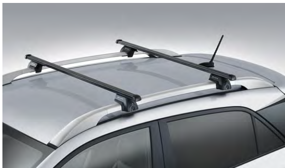
Belki poprzeczne. Dopasowane do relingów dachowych i20 Active belki poprzeczne można błyskawicznie zamontować lub zdjąć. Wykonane z lekkiego i wytrzymałego materiału. E83002E050 (aluminiowe / Active) E83002E000 (stalowe / Active)
