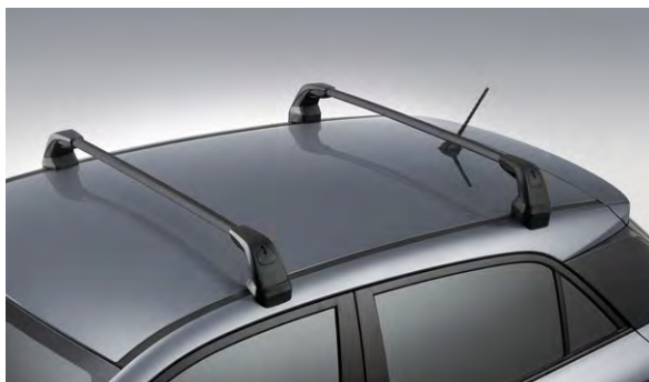
Belki dachowe. Przygotowane specjalnie dla modelu i20, lekkie i wytrzymałe belki dachowe to bezpieczna platforma do montażu różnego rodzaju bagażników. Łatwy montaż i demontaż. Nie nadają się do samochodów z panoramicznym oknem dachowym. C8210ADE00AL (aluminiowe / 5d) C8210ADE10AL (aluminiowe / Coupé) C8210ADE00ME (stalowe / 5d) C8210ADE10ME (stalowe / Coupé)
