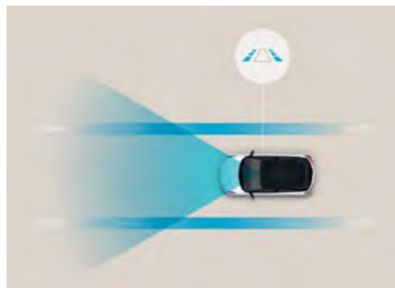
Podążanie na pasie ruchu (LFA) Podczas jazdy z prędkością do 180 km/h system pomaga kierowcy w utrzymywaniu samochodu pośrodku zajmowanego pasa ruchu na autostradzie i w mieście.
