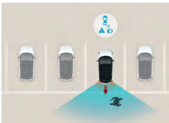
Asystent zapobiegania kolizjom z pieszymi podczas jazdy do tyłu (PCA-R) Ciesz się dodatkowym bezpieczeństwem podczas manewrowania w wąskich miejscach parkingowych na wstecznym biegu. W przypadku wykrycia ryzyka kolizji z pieszym lub przeszkodą system ostrzega i automatycznie włącza hamulce.
