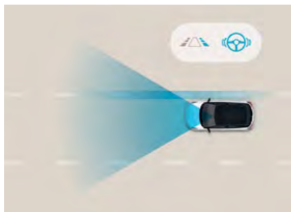
System utrzymywania pasa ruchu (LKA) Obserwuje linie boczne na drodze za pomocą przedniej kamery. W przypadku niezamierzonego opuszczenia pasa, ostrzega kierowcę, a w razie potrzeby dokonuje korekty toru jazdy, aby zapobiec wypadkowi.
