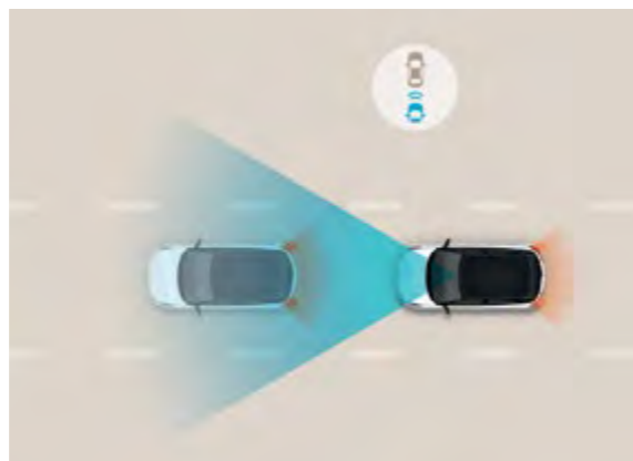
Asystent zapobiegania kolizjom czołowym z wykrywaniem pieszych i samochodów (FCA) Obserwujący drogę za pomocą radaru i kamery system FCA automatycznie hamuje po wykryciu nagłego hamowania pojazdu jadącego z przodu. System wykrywa również pieszych i rowerzystów.
