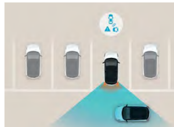
Asystent zapobiegania kolizjom z pojazdami podczas cofania (RCCA) Przy cofaniu w miejscach o ograniczonej widoczności system ostrzega przed pojazdami przejeżdżającymi z tyłu, a w razie konieczności automatycznie uruchamia hamulce.
