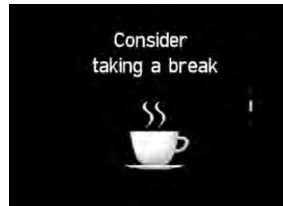
System monitorujący poziom koncentracji uwagi kierowcy (DAW) Po zidentyfikowaniu wzorca zmęczenia lub nieuwagi system zwraca uwagę kierowcy za pomocą sygnału ostrzegawczego i komunikatu na wyświetlaczu, sugerując przerwę.
