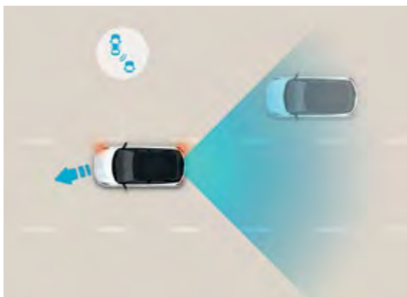
Aktywny system monitorowania martwego pola (BCA) Korzystając z dwóch czujników radarowych w dolnym tylnym zderzaku, system ostrzega o pojazdach poruszających się w martwym polu. Jeśli włączysz kierunkowskaz, system uaktywni alarm dźwiękowy, a następnie zahamuje, aby uniknąć przewidywanej kolizji.
