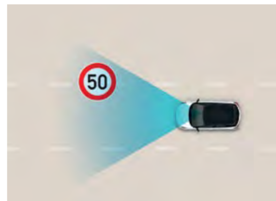
Asystent inteligentnego czytania znaków (ISLA) Ostrzega za pomocą sygnałów dźwiękowych i wizualnych w przypadku przekroczenia dopuszczalnej prędkości. W połączeniu z ręcznym ogranicznikiem prędkości lub inteligentnym tempomatem ISLA może nawet dostosowywać prędkość autonomicznie.
