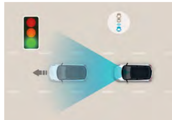
Ostrzeżenie o odjechaniu poprzedzającego pojazdu (LDWA) Ta inteligentna funkcja podczas jazdy po mieście powiadamia kierowcę, gdy pojazd z przodu rusza, na przykład na światłach lub w korku.
