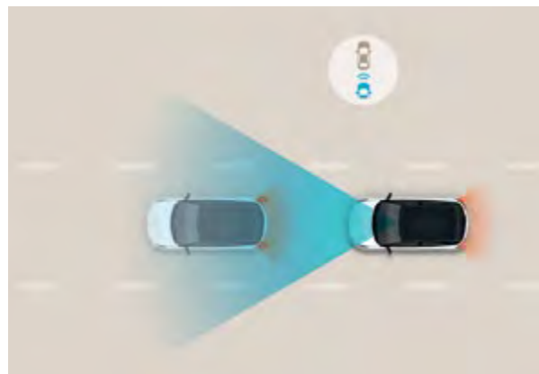
Asystent jazdy autostradowej (HDA) Funkcja ta jest połączeniem asystenta podążania na pasie ruchu i inteligentnego tempomatu wykorzystującego nawigację. Używa ona czujników i danych z nawigacji, aby zapewnić bezpieczną jazdę, automatycznie dostosowując prędkość pokonywania łuków w określonych warunkach.
