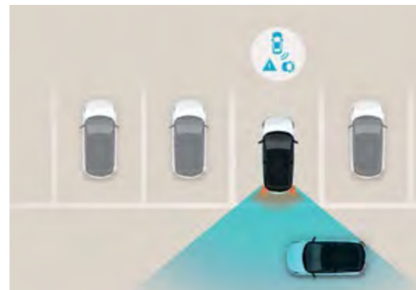
Asystent ostrzegania o ruchu poprzecznym (RCTA) Przy cofaniu w miejscach o ograniczonej widoczności system ostrzega przed pojazdami przejeżdżającymi z tyłu, a w razie konieczności automatycznie uruchamia hamulce.
