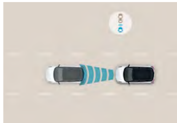
Inteligentny tempomat z zatrzymywaniem i ruszaniem Większe bezpieczeństwo, mniejszy stres. Zachowuje ustaloną odległość do poprzedzającego pojazdu, automatycznie zmniejszając lub zwiększając prędkość do ustalonego wcześniej limitu. W ruchu miejskim SCC utrzymuje ustaloną odległość.
