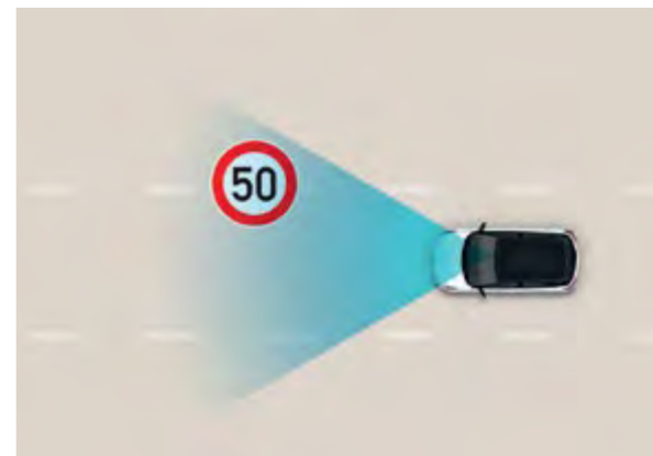
Inteligentny asystent ostrzegania o ograniczeniach prędkości (ISLA) Ostrzega za pomocą sygnałów dźwiękowych i wizualnych w przypadku przekroczenia dopuszczalnej prędkości. Ponadto przypomina o konieczności zmiany ustawionej prędkości tempomatu, aby nie przekraczać ograniczenia prędkości.
