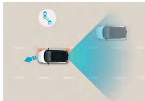
Asystent monitorowania martwego pola (BSA) Korzystając z czujników radarowych w dolnym tylnym zderzaku i kamery przedniej, system ostrzega o pojazdach poruszających się w martwym polu. Jeśli włączysz kierunkowskaz, system uaktywni alarm dźwiękowy, a następnie zahamuje, aby zapobiec przewidywanej kolizji.
