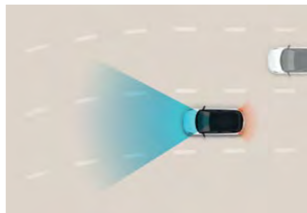
Inteligentny tempomat wykorzystujący nawigację (NSCC-C) Wykorzystuje zaawansowany system nawigacji do przewidywania zbliżających się zakrętów lub prostych na autostradzie i automatycznie dostosowuje prędkość w celu bezpieczniejszej jazdy.
