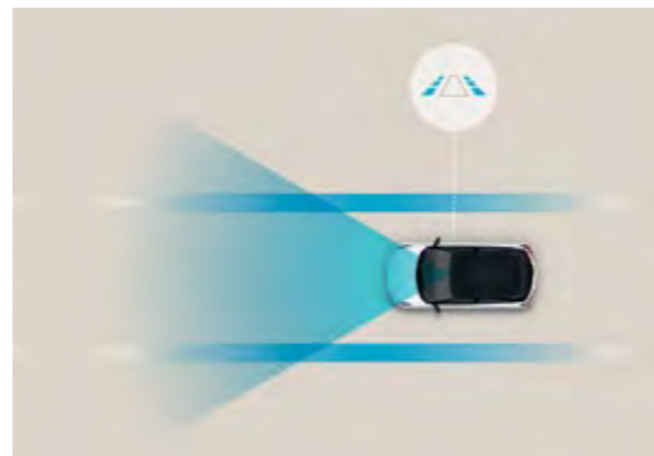
Asystent podążania na pasie ruchu (LFA) Zapewnia bezpieczeństwo, trzymając się środka pasa ruchu. Podczas jazdy z prędkością do 180 km/h system pomaga kierowcy w utrzymywaniu samochodu pośrodku zajmowanego pasa ruchu na autostradzie i w mieście.
