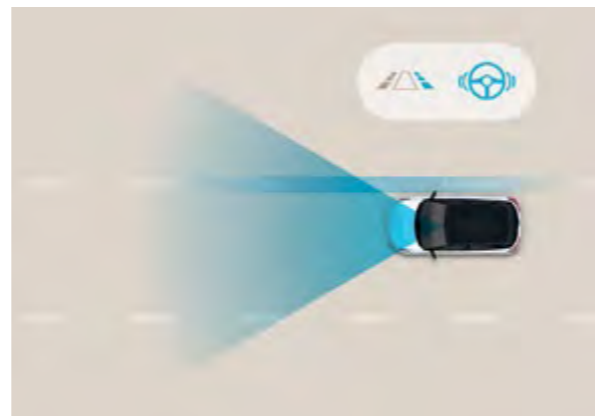
Asystent utrzymywania pasa ruchu (LKA) Obserwuje linie boczne na drodze za pomocą przedniej kamery. W przypadku niezamierzonego opuszczenia pasa, ostrzega kierowcę, a w razie potrzeby korekty toru jazdy, aby zapobiec wypadkowi.
